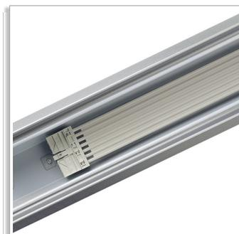
Maxos 4MX656 TL5 стандартная магистральная секция с 7-проводным плоским кабелем (7 x 1,5 / 7 x 2,5); для диммирования (1-10 V), DALI или аварийное освещение с собственным аккумулятором
