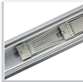
Maxos 4MX656 TL5 стандартная магистральная секция с 7-проводным плоским кабелем (2 x 7 x 1,5 / 2 x 7 x 2,5); для создания различных диммируемых зон освещения в помещении или отдельной аварийной сети освещения
